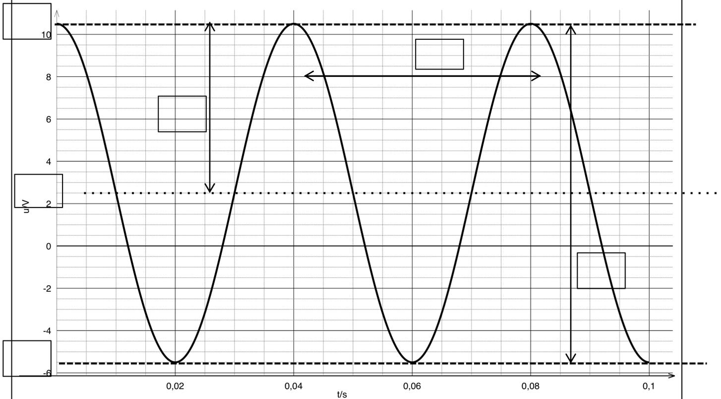
1. Compléter les cases vides présentes sur la représentation temporelle du signal, en indiquant les grandeurs suivantes :  $T$  (la période du signal),  $U_{max}$  (valeur maximale du signal),  $U_{min}$  (valeur minimale du signal),  $U_{cc}$  (tension crête à crête),  $U_m$  (amplitude du signal) et  $\langle u \rangle$  (valeur moyenne du signal).
