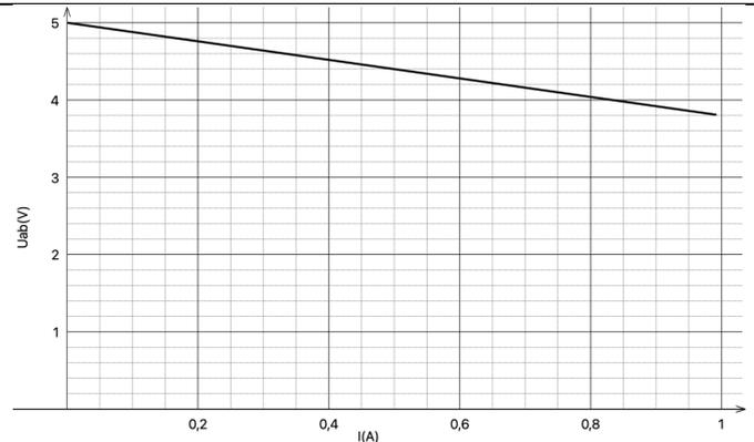
Si  $I = 0$ , alors le générateur réel délivre une tension au reste du circuit  $U_{AB} = E$
