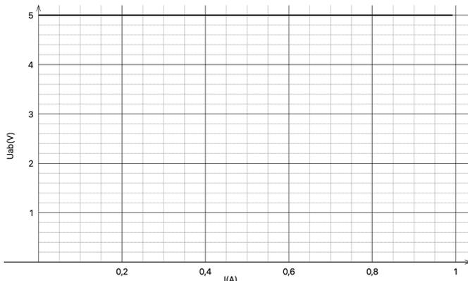
Quelle que soit l'intensité  $I$  débitée par le générateur, la tension  $U_{AB}$  aux bornes du générateur est toujours la même :
