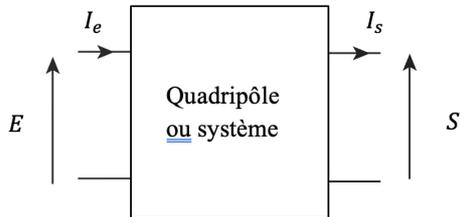
$E$  : signal/tension d'entrée du quadrupôle, en volt
