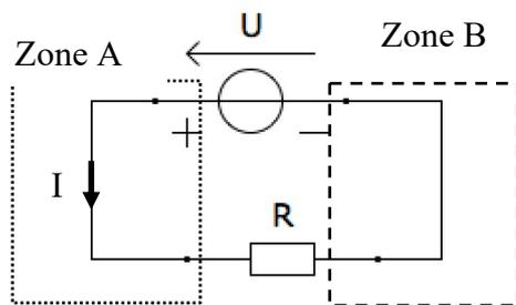
Des électrons libres peuvent donc quitter la zone B pour aller dans la zone A en traversant le conducteur ohmique. Une fois arrivés dans la zone A, des électrons libres sont réinjectés dans la zone B par le générateur, afin de maintenir le déséquilibre des potentiels électriques entre les deux zones.
