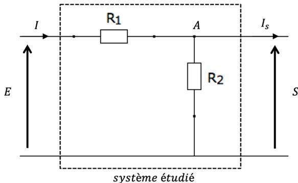
Pour un système « pont diviseur de tension », la formule littérale liant la tension de sortie, à la tension d'entrée est la suivante :
