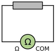
Le mesurage d'une résistance électrique s'effectue à l'aide d'un ohmmètre, branché aux bornes du dipôle étudié, en dehors du circuit.
