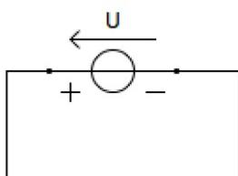
Soit un signal constant  $U$ . Ce signal « seul » ne peut ni fournir de l'énergie à l'extérieur, ni recevoir une énergie de l'extérieur. L'énergie électrique du signal est donc constante : elle ne varie pas  $\Delta E = 0 J$
