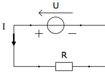
Le conducteur ohmique est parcouru par un courant électrique (débit d'électrons traversant une section de conducteur) : il y a conversion d'énergie.
