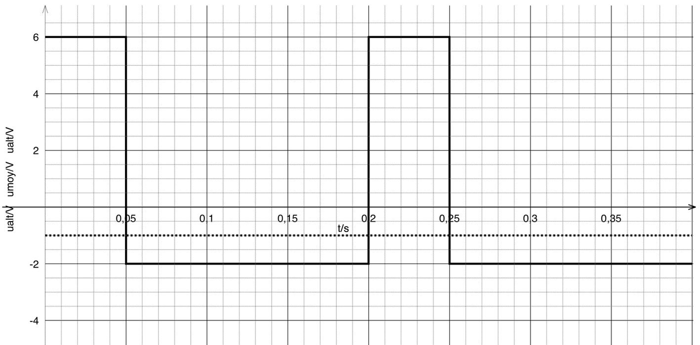
25. Sur les graphes suivants, à partir du tracé du signal  $u(t)$ , tracer en rouge sa composante alternative  $u_{alt}(t)$  (en trait plein) et sa composante continue (en pointillé) :
