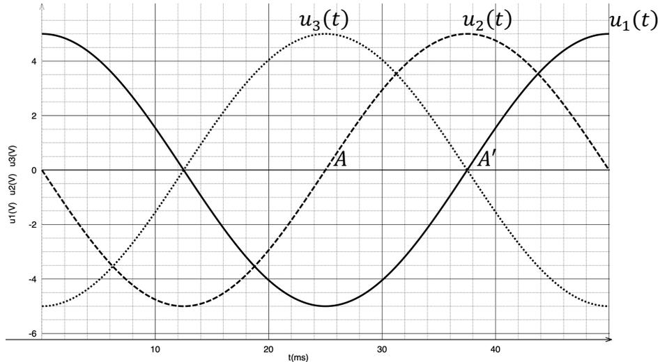
Graphiquement, on observe que  $u_2$  est en avance par rapport à  $u_1$  : en effet, le point A (intersection du signal avec l'axe des abscisses dans le sens montant) est atteint par le signal  $u_2$  avant le signal  $u_1$  (point A').
