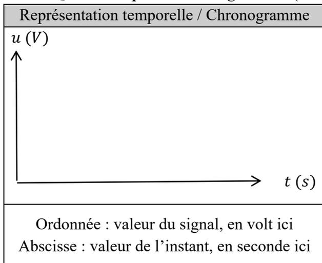
Dans ce chapitre, on s'intéresse à la représentation (graphique) temporelle d'un signal (dans l'ensemble du chapitre, les signaux sont des tensions électriques). On représente donc :
