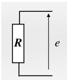
On mesure le signal  $e(t)$  aux bornes d'un conducteur ohmique, en l'absence de générateur.
