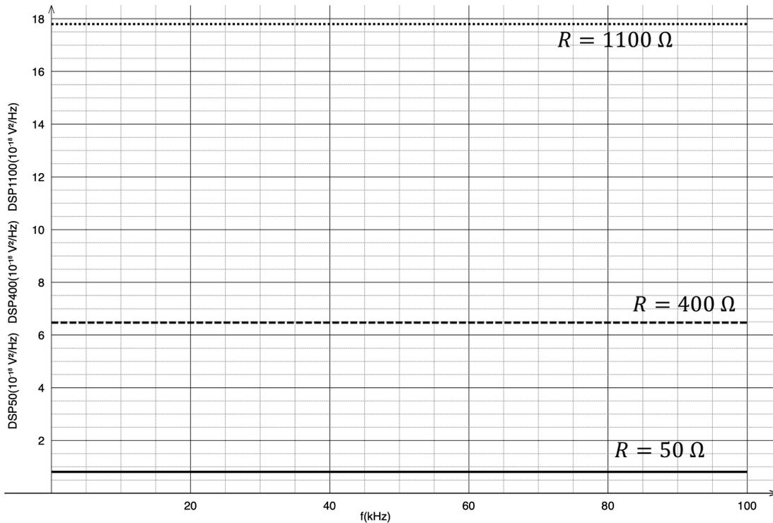
42. Déterminer la puissance moyenne normalisée du bruit  $P_{bruit}$ , en  $V^2$  pour un conducteur ohmique de résistance  $R = 400 \Omega$  contenu dans un système dont la bande passante est  $[20kHz; 60 kHz]$  :
