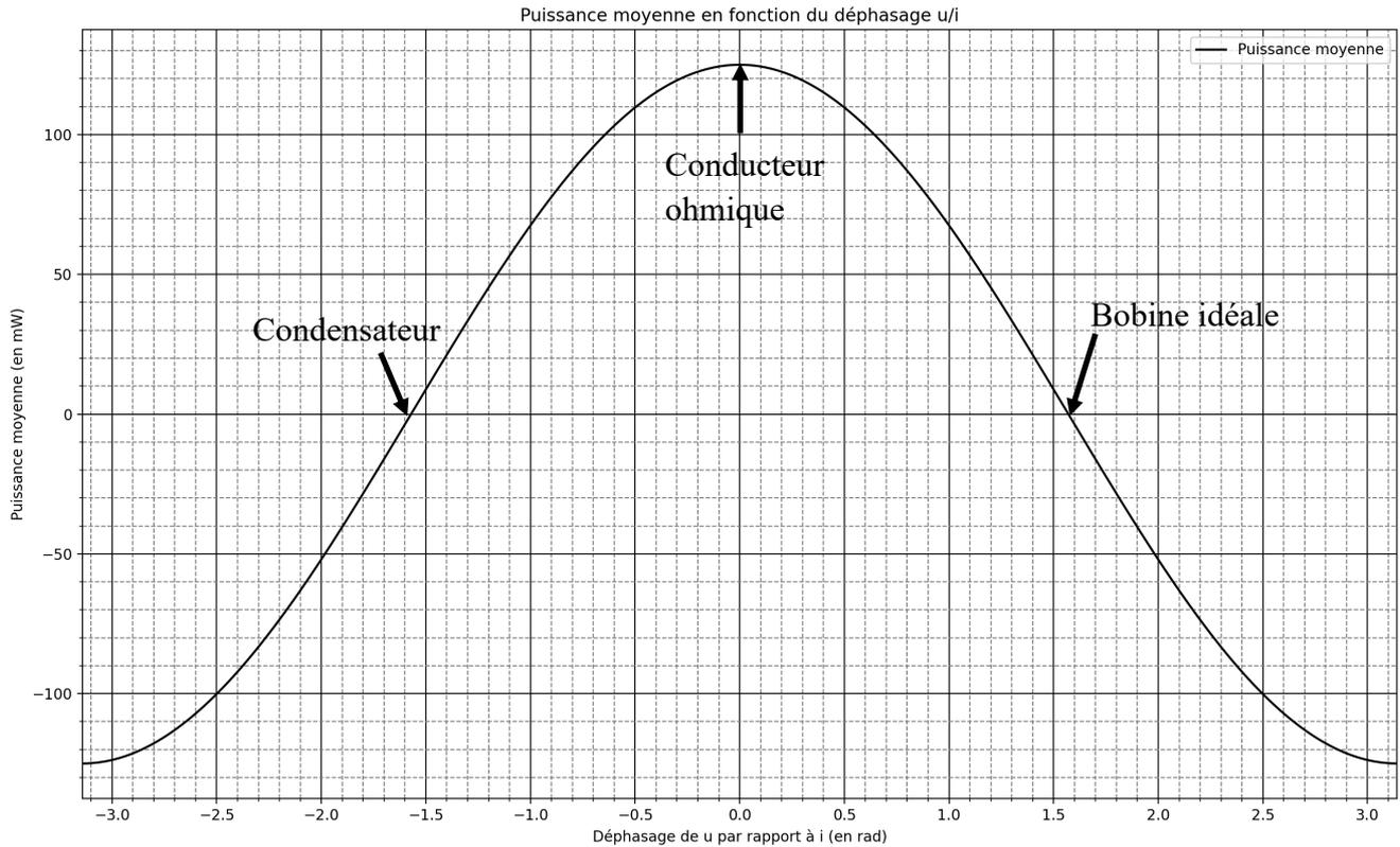
8. Sur ce graphe, tracer les points correspondant à la bobine idéale, le condensateur et le conducteur ohmique.
