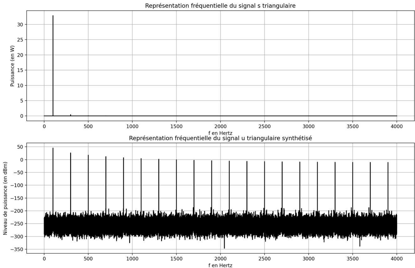
34. Déterminer la puissance active portée par l'harmonique de rang 1 en watt puis en  $dBm$ , puis vérifier que les valeurs lues sur le spectre correspondent.
