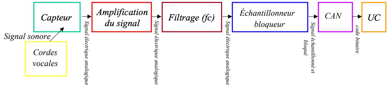
11. Compléter à l'aide du vocabulaire suivant le schéma fonctionnel (partiel) de la chaîne de numérisation : signal sonore, signal électrique analogique, signal échantillonné et bloqué, code binaire.
