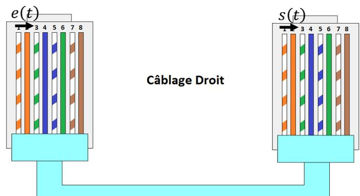
1. Tracer les flèches représentant la tension  $e(t)$  et la tension de sortie  $s(t)$  sur le schéma du câble ETHERNET.
