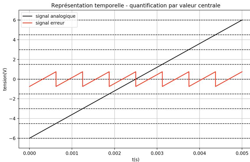
Le **rapport signal sur bruit** d'un CAN idéal est défini pour un signal d'entrée triangulaire alternatif (signal analogique) dont la valeur crête à crête correspond à la tension pleine échelle du CAN. Le CAN procède par valeur centrale.
