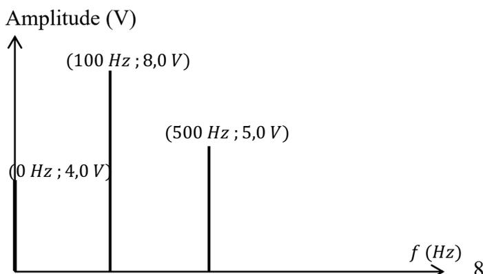
On étudie un signal analogique  $s(t)$  de fréquence  $f = 100 \text{ Hz}$ . Son spectre en amplitude est celui tracé à gauche.
