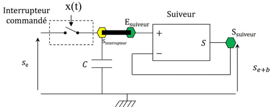
Ainsi lorsque  $x(t)$ , est dans l'état haut, l'interrupteur commandé est fermé et le signal analogique est transmis aux bornes du condensateur : le condensateur est chargé à 95% au bout d'une durée égale à  $\Delta t_{5\%} = 3RC$  (ici  $R$  est la résistance des fils). La tension aux bornes du condensateur est donc rapidement égale à celle de  $s_e(t)$ .
