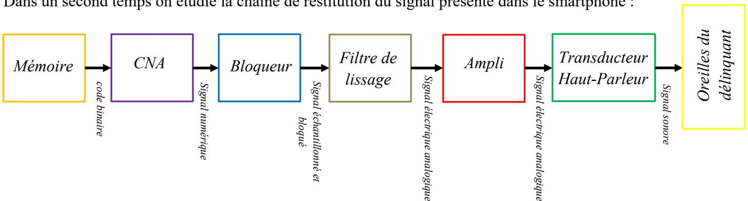
12. Compléter à l'aide du vocabulaire suivant le schéma fonctionnel (partiel) de la chaîne de restitution : signal sonore, signal électrique analogique, signal échantillonné et bloqué, signal numérique, code binaire.
