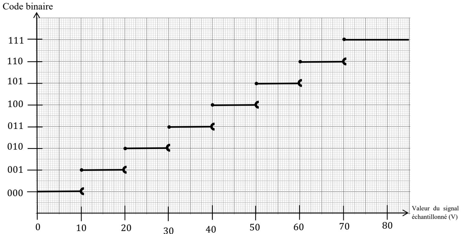
44. A l'aide de cette caractéristique, déterminer le code binaire, puis le nombre décimal  $M_{(10)}$ , en sortie du CAN si  $s_e = 73 V$  :
