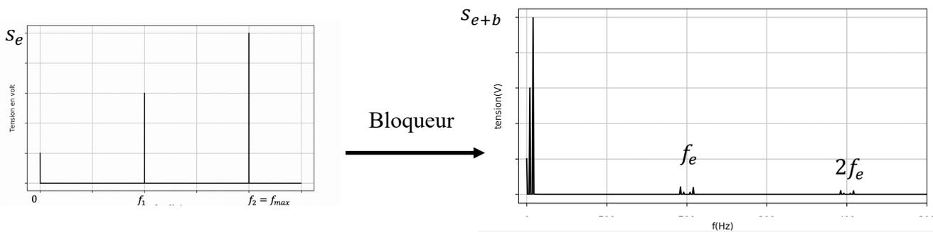
Le signal échantillonné et bloqué contient des raies dont les abscisses sont  $k \times f_e \pm f_n$  avec  $k \in \mathbb{N}^*$  et  $n \in \mathbb{N}^*$ . La représentation fréquentielle de  $s_{e+b}$  est identique à celle de  $s_e$  pour les fréquences des raies, mais l'amplitude de chacune des raies n'est plus la même (atténuation en sinus cardinal)
