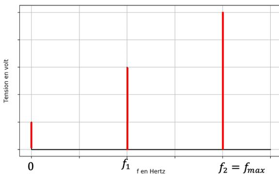
Soit un signal  $s(t)$  périodique analogique, de fréquence  $f_1$  dont la représentation fréquentielle est donnée ci-contre.
