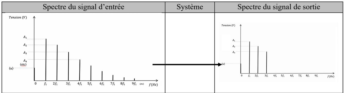
Ici,  $f_c$  est comprise entre  $3f_1$  et  $4f_1$  : la fréquence maximale du signal devient alors  $f_{max} = 3f_1$
