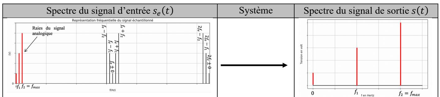
Il faut que le domaine des fréquences des raies provenant de l'échantillonnage ne vienne pas empiéter sur le domaine des fréquences du signal analogique.
