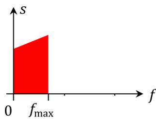
On étudie un signal analogique  $s(t)$  **non périodique** dont la représentation fréquentielle possède une continuité de raies comprises entre 0 Hz et une fréquence maximale, notée  $f_{max}$ .
