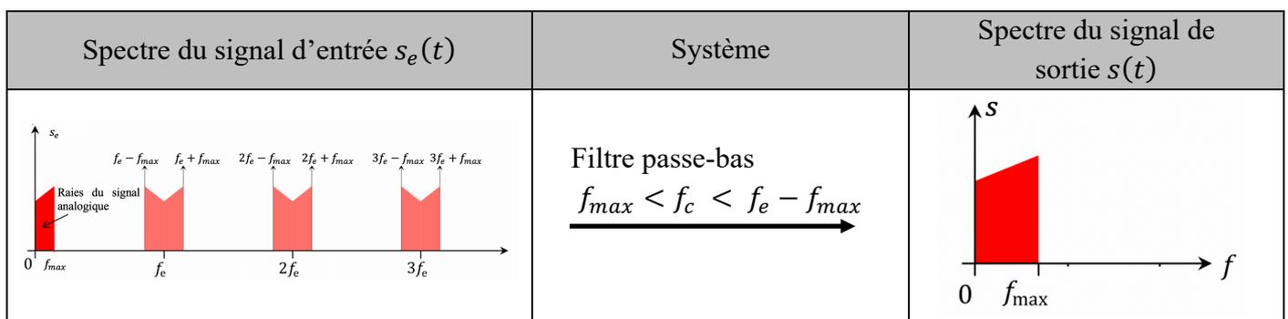
L'échantillonnage est ici une opération réversible : le signal a alors été correctement échantillonné.
