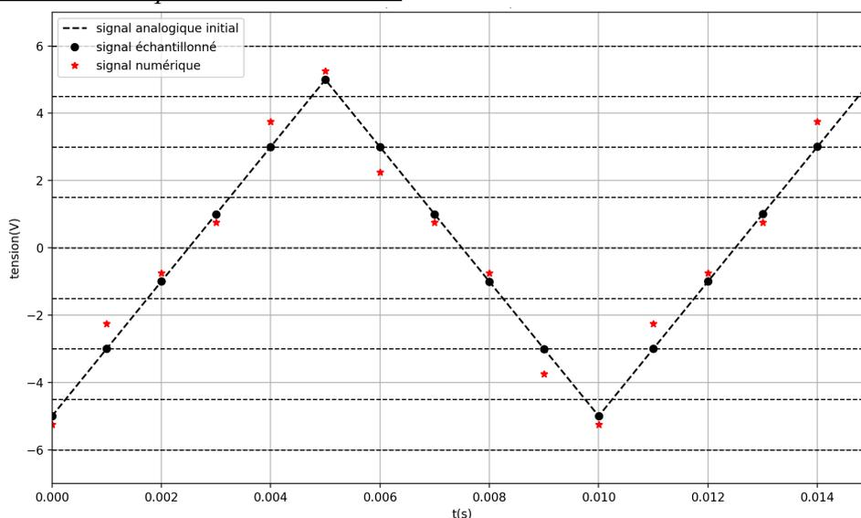
Le signal  $x$  à la sortie du CNA est donc un signal numérique.
