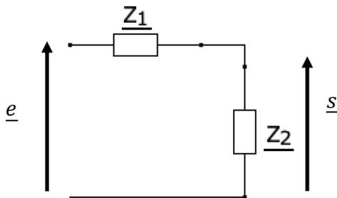
Soit deux impédances complexes  $\underline{Z}_1$  et  $\underline{Z}_2$  placées en série (parcouru par un même courant – schéma ci-contre).
