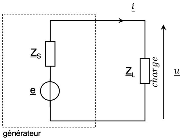
L'adaptation d'impédances est une technique en électricité, permettant d'optimiser le transfert d'une puissance électrique entre un émetteur (source) et un dipôle récepteur électrique (charge).
