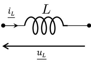
En convention récepteur, **en régime sinusoïdal forcé**, l'impédance complexe  $\underline{Z}_L$  de la bobine idéale (sans résistance liée au fil de cuivre), d'inductance  $L$ , est :
