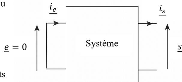
On a donc le schéma équivalent suivant pour le système (avec le générateur en entrée éteint):
