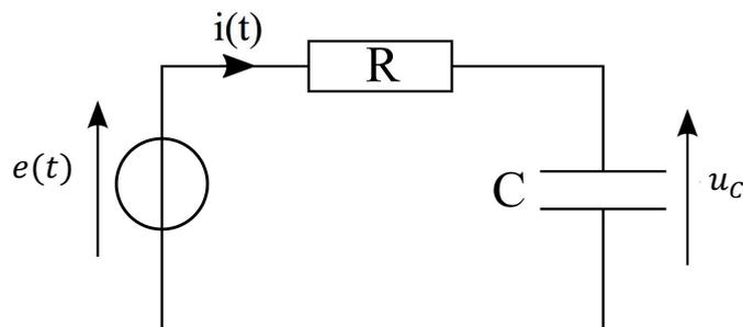
1ère étape : on schématise le circuit équivalent à basses fréquences
